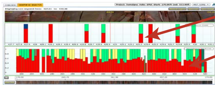
使用 TerraSpec® 点检测并与岩芯图片结合的数据输出示例
