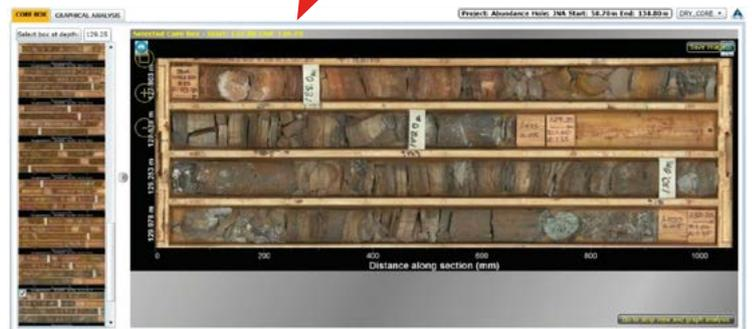
缩放工具允许您检查每个岩芯箱，只受数码照片分辨率的限制。
