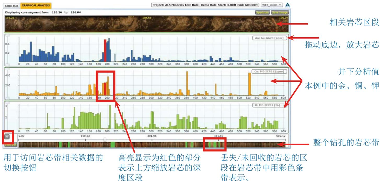
岩芯带视图和图像分析窗口便于将岩芯照片与其他相关数据（如地质地球化学检测数据、高光谱数据和钻孔地球物理数据）集成。
